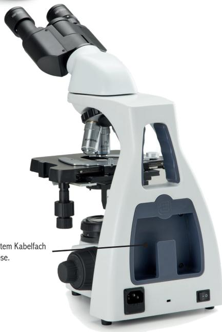
Rückseite mit integriertem Kabelfach und Kaltgerätesteckdose.
